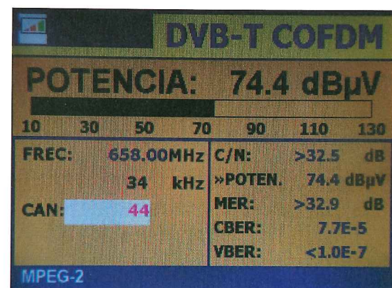
Figura 3.65. Medida de la potencia de la señal.
