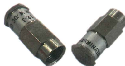
Figura 3.25. Resistencias de terminación de 75 Ω.
